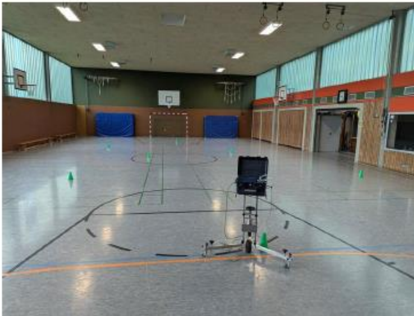
Bild 7: Anordnung der Messpunkte und Bestimmung des Kraftabbaus auf Messpunkt 1
